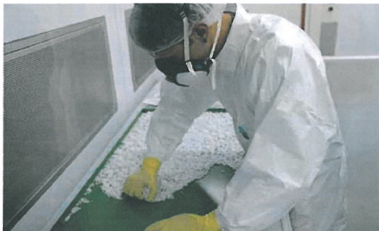
La preparazione dell'elastomero dalle elevatissime prestazioni. La produzione (sotto, l'impianto da tre milioni di euro) avviene in atmosfera controllata (FOTO PANARELLO)
